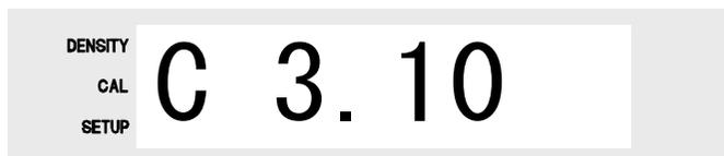
6. キャリブレーションが完了すると、[CAL END]と表示され、測定モードに戻ります。[CAL ERR!]と表示される場合にはもう一度キャリブレーションを行ってください。
