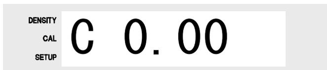
5. 次に、[READ STD]と表示されますので、校正フィルム(STEP 4)を測定します。[C 3.10]というように入力した値が表示されたらアームを放します。
