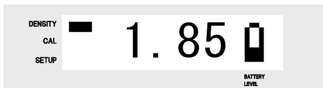
バッテリーの残量に応じて7段階に変化します。残量が0%になったら充電してください。
