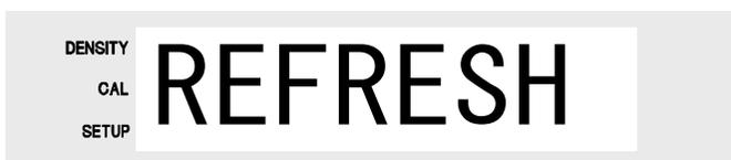
4. バッテリーリフレッシュが作動して、充電ランプが緑色に変わり、放電が開始されます。放電中の電圧値が点滅表示されます。
